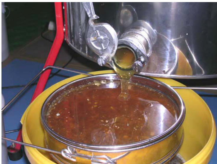
Figura 17. Extractor, tanque de sedimentación y filtros, todos hechos de acero inoxidable.
