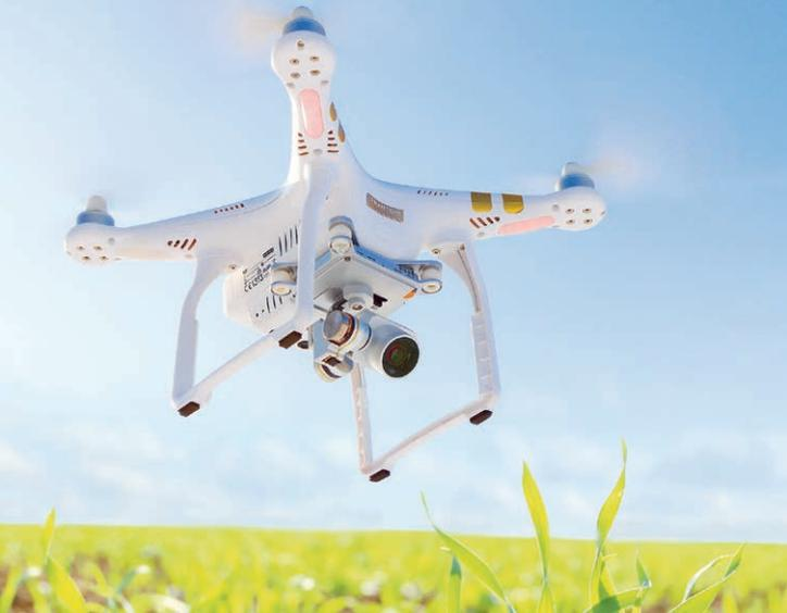
Des caméras à haute définition permettent de déterminer l'état de santé et la vigueur des plantes (ici du blé) à l'aide d'une analyse spectrale.
